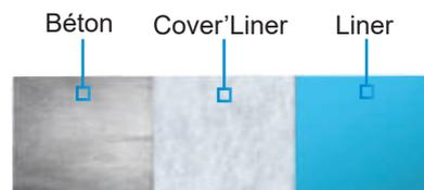
Surface légèrement fibreuse en contact avec le béton
